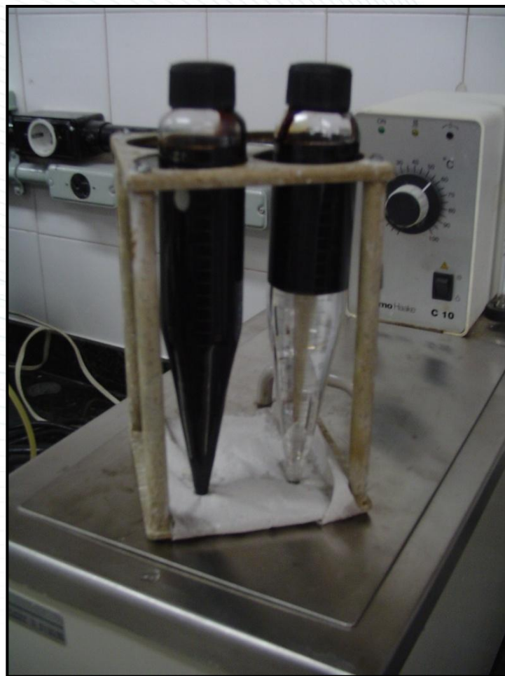
Figura 12 – Teste de garrafa para separação de emulsão.
