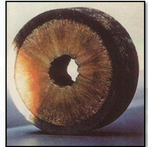
Figura 1 – Redução da seção útil de escoamento.
